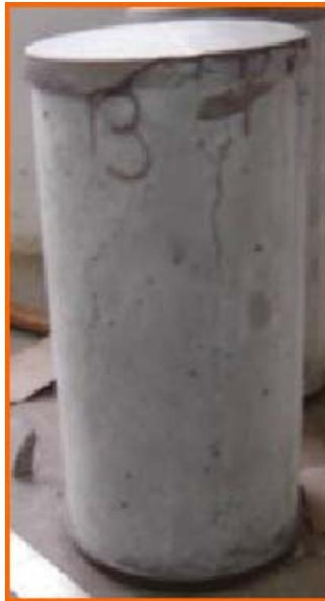
*Fig. 3 - Probeta de hormigón simple. Modo de falla*
