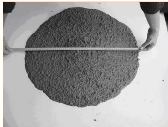
Fig. 4 - Aspecto del hormigón en ensayos de extensión
