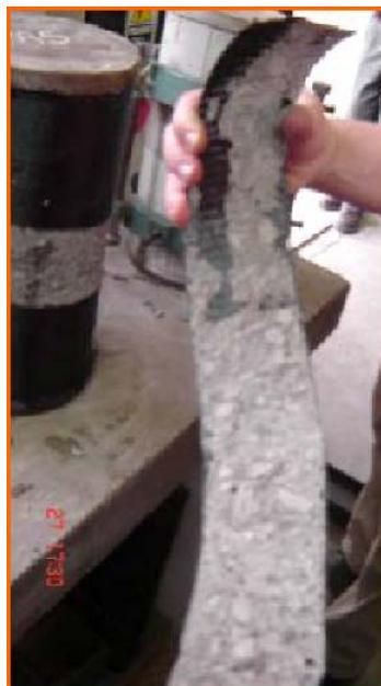
*Fig. 6 - Rotura de la interfase material compuesto-hormigón*
