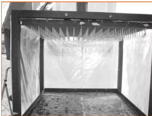
*Fig. 5 - Puesta en régimen del simulador de lluvia*
