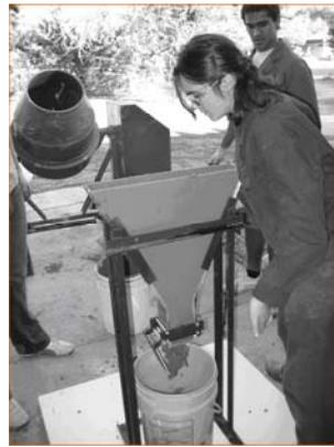
*Fig. 10 - Ensayos con el V-Funnel*
